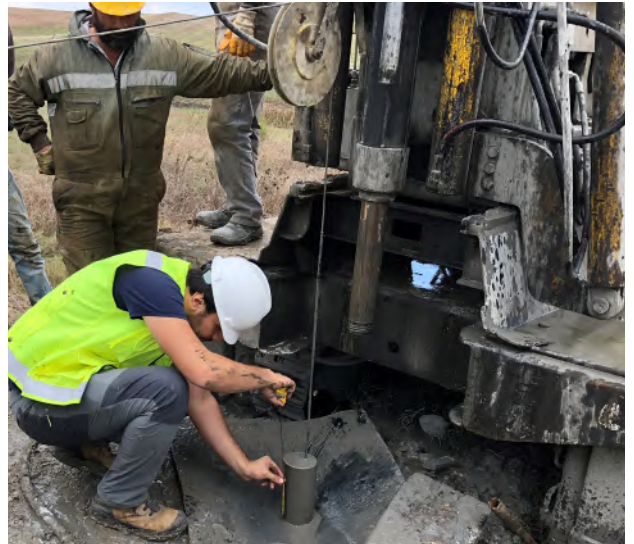
Sondanın kuyuya indirildikten sonraki kuyu ağzı ölçümü
